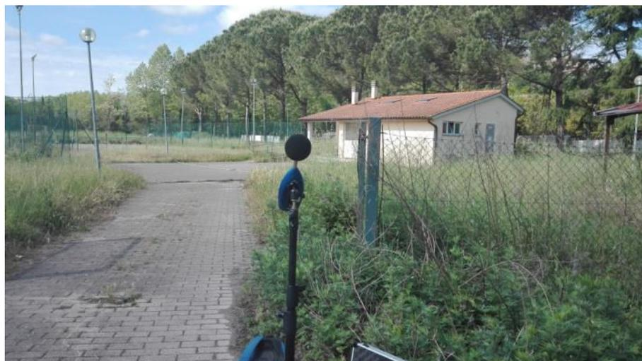
FIGURA 17. RESTITUZIONE FOTOGRAFICA POSTAZIONE DI MISURA
